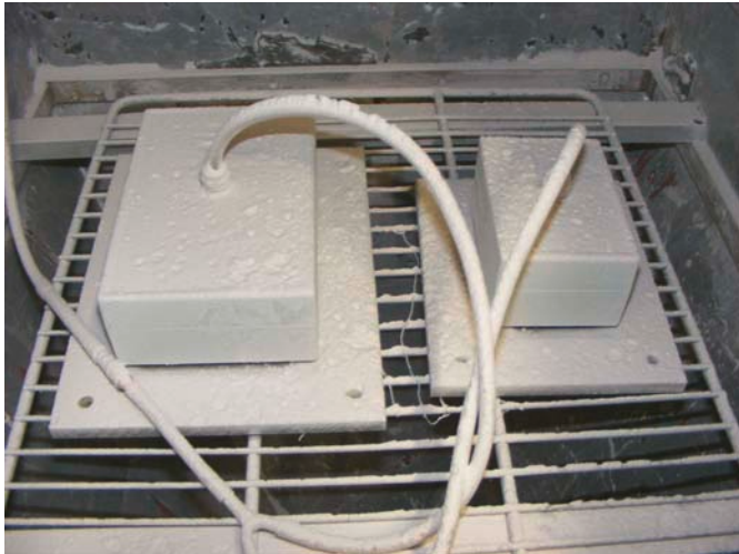
Bild 8 Belastung durch Staub IP 6X
