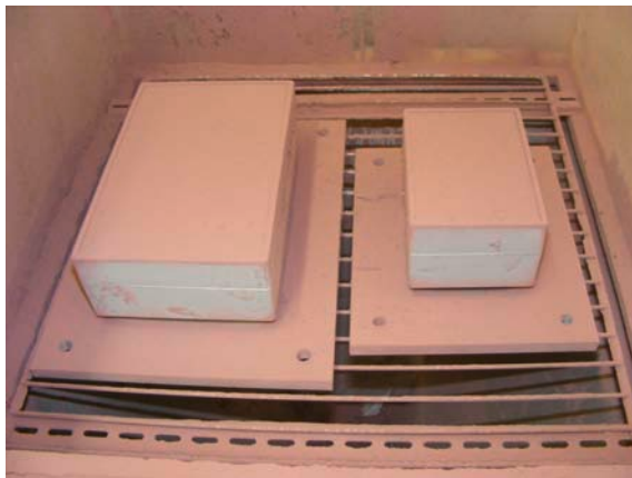
Bild 11 Belastung durch IP 6KX
