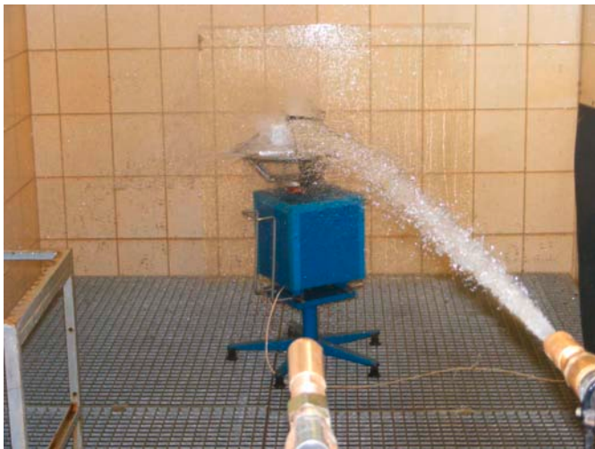
Bild 9 Belastung durch Wasser IP X6, beispielhaft
